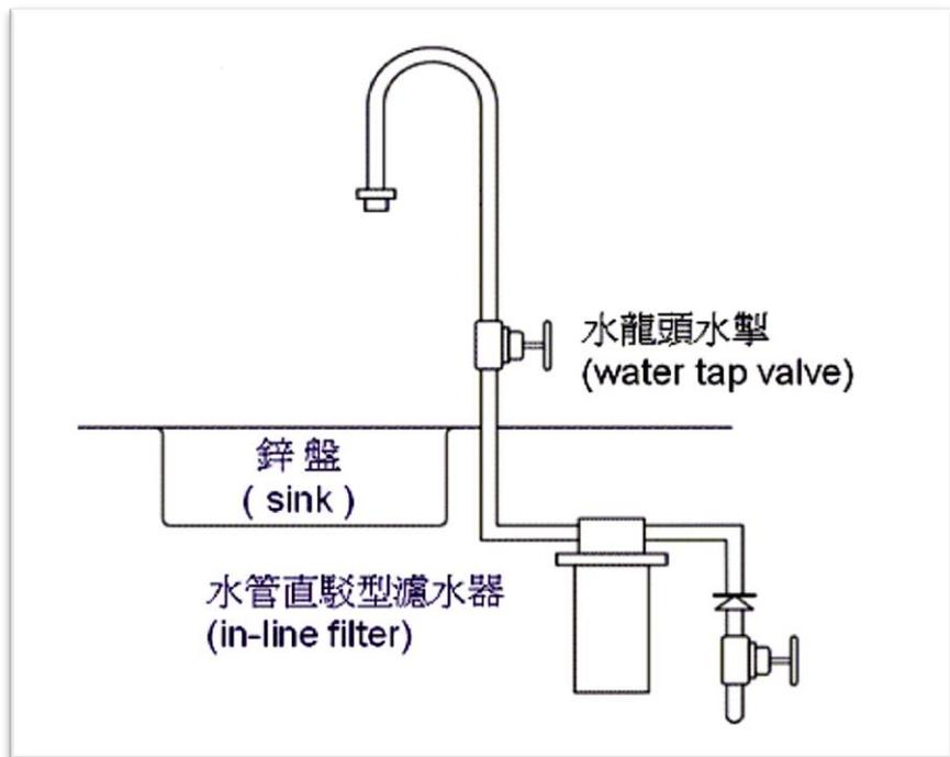
除上述類型的濾水器外（例如水管直駁型濾水器），便須按「水務設施規例」聘用持牌水喉匠安裝。
