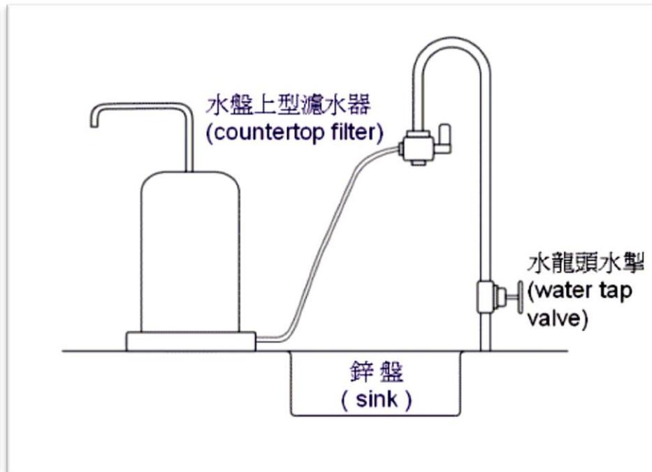
如安裝的濾水器是**水龍頭裝套型**或**水盤上型**，而下游沒有設置斷流閥，則屬性質輕微的內部供水系統更改，無須向水務署申請。
