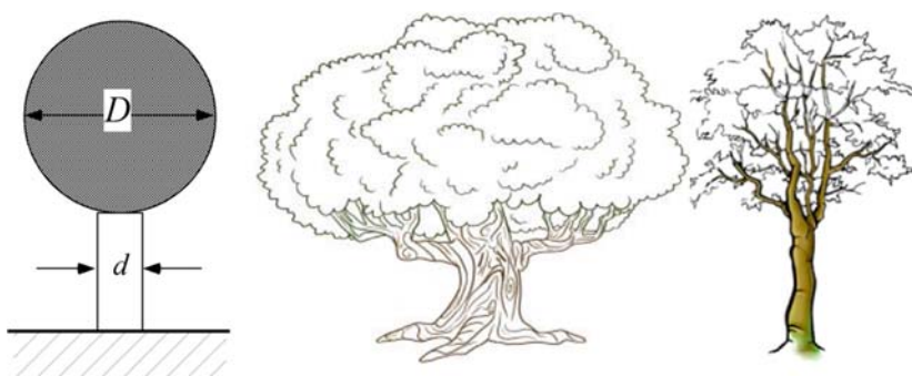
圖 2.1 支柱和負荷直徑的比例。
