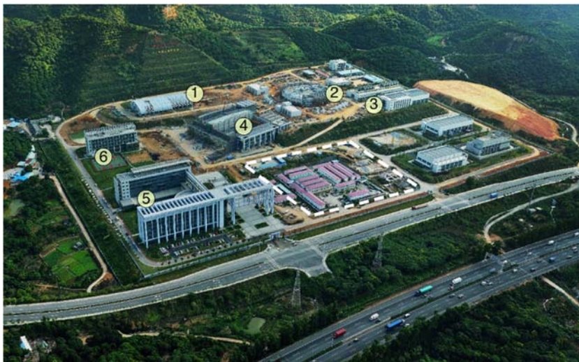
圖 7.10 中國散裂中子源（CSNS）工地的進展照片（2015 年 12 月）。1 質子直線加速器（地下），2 同步加速器，3 設備裝置樓叢，4 靶站和散射大廳，5 辦公和實驗樓，6 用戶樓。
