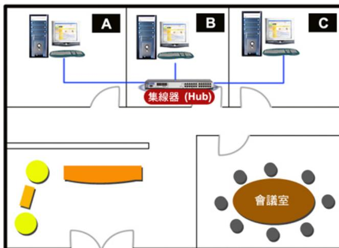
按照圖中的佈線方式，集線器應放在房間 B，所以要製作三條網絡線，一條直接與房間 A 的電腦相連，另外兩條與房間 B、C 的電腦相連。
