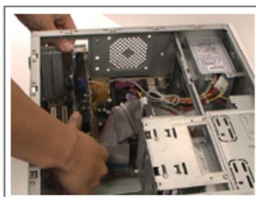
步驟 3：蓋好機殼，從機背可以看好到安裝的網絡卡 RJ-45 連接埠。
