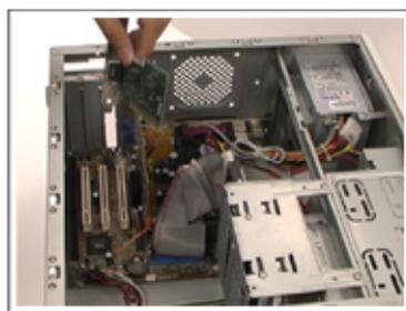
步驟 2：將網絡界面卡檔板朝後，對準剛剛已經卸除的檔板所對應的空 PCI 槽插入網絡界面卡，並以螺絲固定位置。
