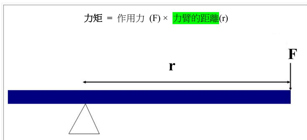
在體育活動中應用槓桿原理的例子很多，例如高爾夫球杆的長度會影響擊球的距離。假設能保持揮杆的角速度不變，運用長杆可擊出較遠的距離，而運用短杆所擊出的距離便較近（揮杆的力度可能有所不同）。
