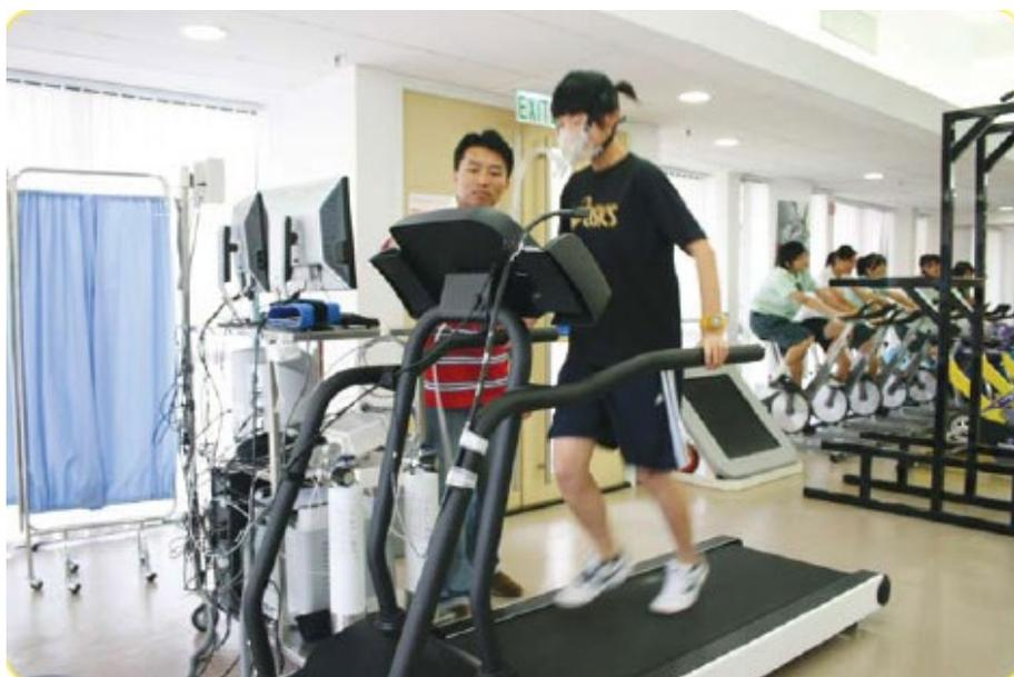
圖 4.2 利用跑步機及氣體分析儀量度最大攝氧量
