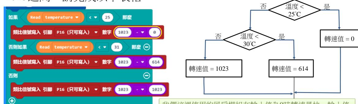
我們這裡使用的風扇模組在輸入值為0時轉速最快,輸入值為1023時轉速為0。因此,以上的例子使用1023減去轉速值
