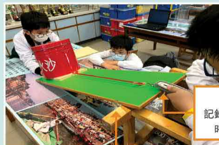
利用木椅和膠板製作成斜台， 模擬BB車於斜路行走時的情況
