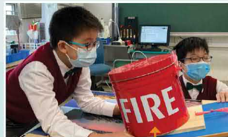
防火沙（重物）： 對木板進行施壓，增加木板 與斜板的摩擦力
