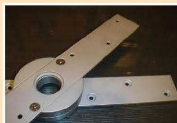
物件在同一中心點（支點）下旋動 例子：電視機轉架、門鎖
