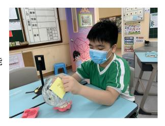
微波爐400w加熱2分鐘。然後開始測試哪款澱粉加上蛋殼形成的物料的重量、堅固度、分解性、防水性及耐熱性。
