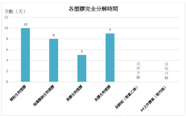
圖五: 各類塑膠生物可分解性棒形圖
