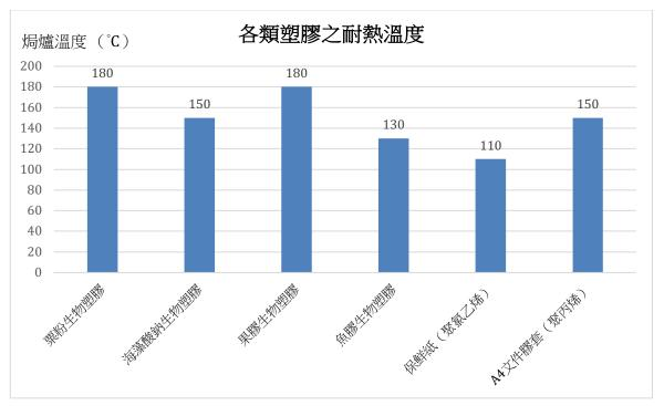
圖一: 各類塑膠耐熱溫度棒形圖
