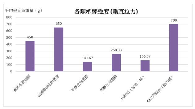
圖二: 各類塑膠垂直拉力棒形圖
