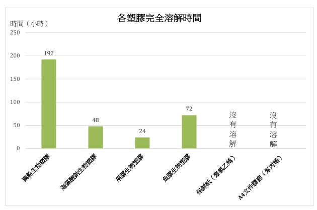
圖四: 各類塑膠水溶性棒形圖
