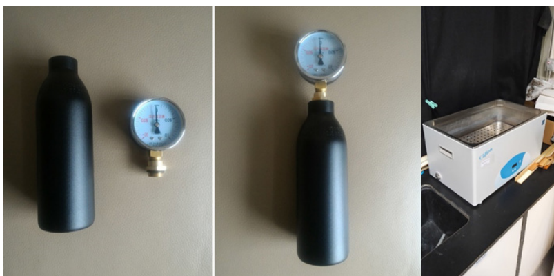
圖：(由左至右) 加壓氣體用的金屬罐、壓強計、熱水浴
