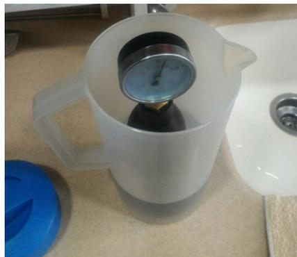
示例：連接着壓強計的密封罐浸於熱水中
