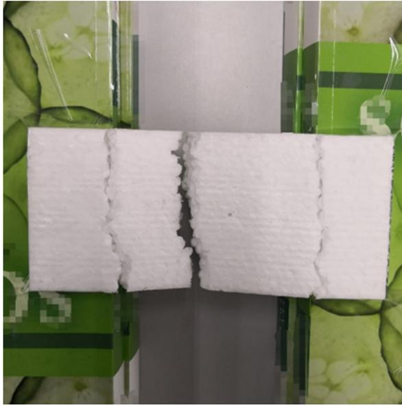
圖1.：沒有加固的聚苯乙烯板撞擊測試後的情況。
