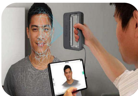
3D掃描儀 (通過物件深度測量) → 人面辨識效果
